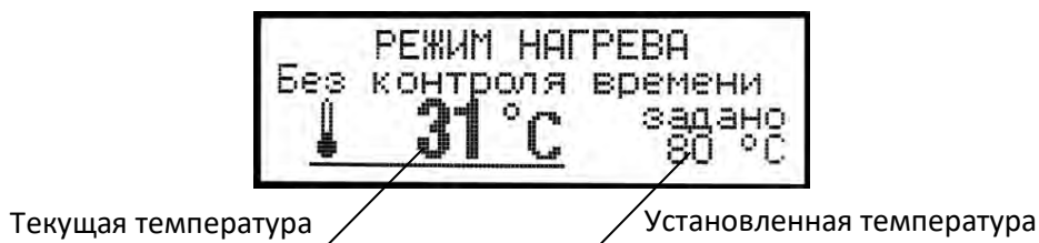
Рисунок 9 – Вид дисплея в состоянии нагрева без контроля времени
